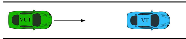
图 6.27 前车静止测试场景示意图
