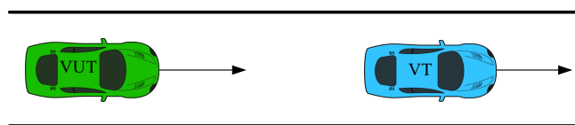
图 6.28 前车制动测试场景示意图
