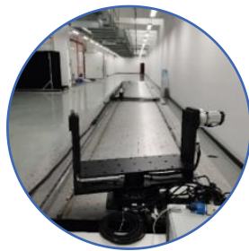
激光雷达定位-全站仪(激光测距仪)校准
