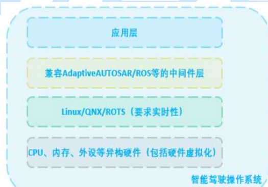
图12 智能驾驶操作系统分层示意图
