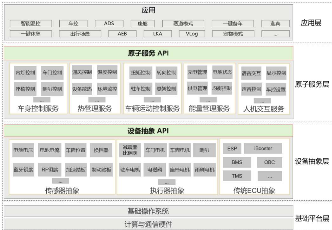
图16 《软件定义汽车服务 API》架构
